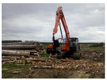
Рис. 4. Раскряжевка хлыстов мультифункциональной машиной на верхнем складе
