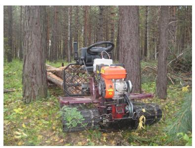
Puc. 6. Предварительная подготовка лесосеки мини-трактором Fig. 6. Preliminary preparation of the cutting area by a mini tractor
