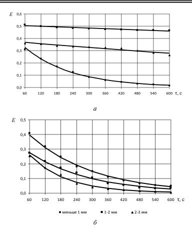
Рис. 2. Зависимость степени недоизвлечения E от продолжительности экстракции  $\tau$  для различных фракций луба (a) и березовой коры  $(\delta)$
