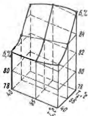
Влияние температуры обработки перуксусной кислотой на конечную белизну целлюлозы ( $T_I$  — температура первой ступени обработки;  $T_{II}$  — температура второй ступени обработки;  $B$  — белизна)
