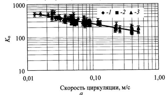
Рис. 4. Зависимость интенсивности теплоотдачи от скорости циркуляции
